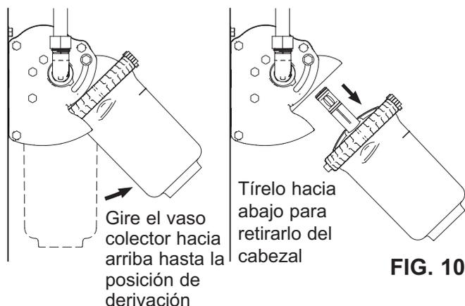
2. Tire del vaso colector hacia abajo fuera del cabezal.
